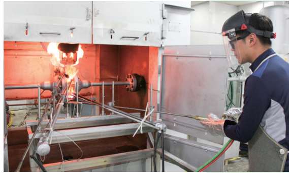
고기능성밸브 기술지원센터의 밸브 화재 시뮬레이션(Fire Safety)시험
